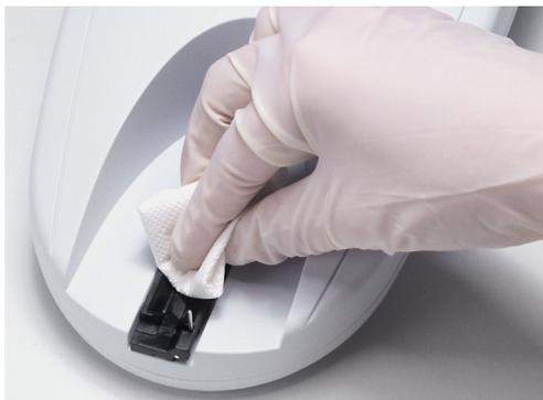
Abb. 75: Reinigung Urisys® 1100 – Teststreifenschlitten mit Referenzfeld
