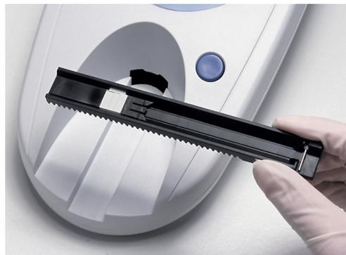
Am Ende des Arbeitstags wird der Urisys® 1100 ausgeschaltet. Der Teststreifenschlitten wird nach vorne aus dem Gerät herausgezogen und die Teststreifenauflagefläche unter fließendem Wasser abgespült. Zur Nachreinigung wird mit entionisiertem Wasser gespült. Die Desinfektion erfolgt nur bei stark kontaminiertem Schlitten mit 70%igem Alkohol.
