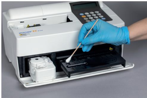
Abb. 70: Spotchem®-Trocknen des Reagenzträgers
